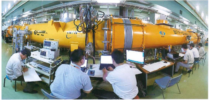
クライオモジュールを冷却し、性能試験をしているところ
