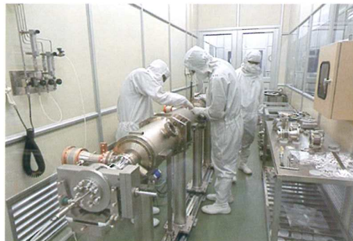
超伝導加速空洞の連結接続作業
