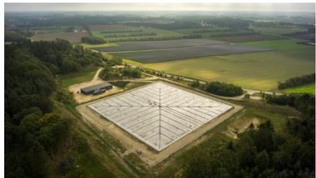
熱供給は、太陽熱から得られた熱量が約40% (そのうち、約80%が蓄熱槽に貯蔵利用)
